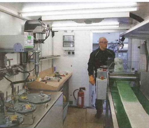
Top-Qualität durch abgestimmte Rezeptur: In der Harzmischanlage werden Harz und Härter optimal temperiert, dosiert und gemischt.
