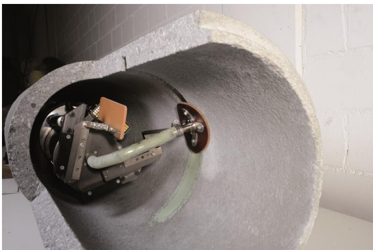
Bild 6: Spachtelroboter (Quelle: Fa. Prokasro)
