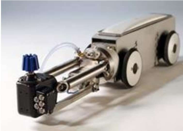
Bild 5: Fräsroboter (Quelle: Fa. Prokasro)
