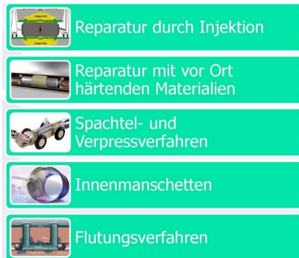
Bild 1: Einteilung Reparaturverfahren nach DIN EN 15885 [2]
